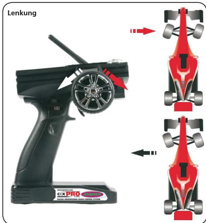
Mit dieser Funktion wird die Lenkung, die Richtungssteuerung durchgeführt. Bei einer Drehung des Steuerrades, müssen die Räder der Vorderachse in die entsprechende Richtung ausschlagen. Wenn das Rad nach rechts gedreht wird, müssen, wie im oberen Bild zu erkennen, die Räder nach rechts ausschlagen. Im nebenstehendem Bild ist der Ausschlag für eine Linkskurve zu sehen.
