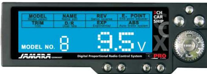
Sinkt die Spannung unter 9.5V, zeigt dies das Display an.
