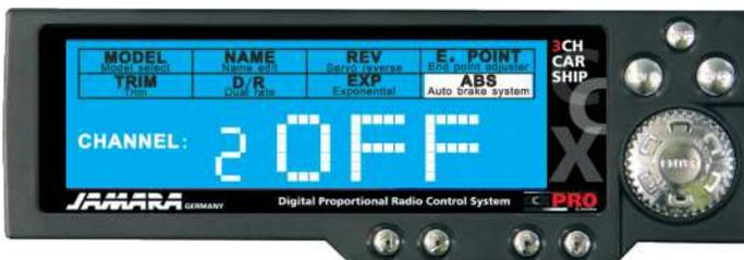
Mit dieser Einstellung können Sie bestimmen ob Ihr Modell bzw das Gas-Bremsservo über die ABS-Funktion verfügen soll. Diese Bremshilfe hilft das Blockieren der Räder zu verhindern.
