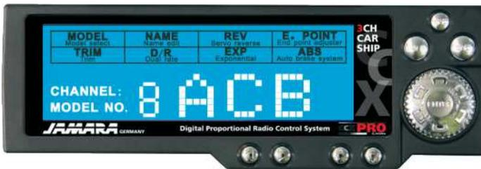
Wird der Sender eingeschaltet, zeigt das Display die Spannung in Volt sowie die Nummer (hier Nr. 8) und die Bezeichnung (hier ABC) des Modells an.
